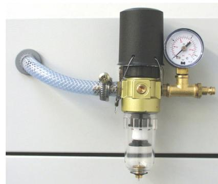
Рисунок 11: Подсоединение подачи сжатого воздуха с сепаратором конденсации
